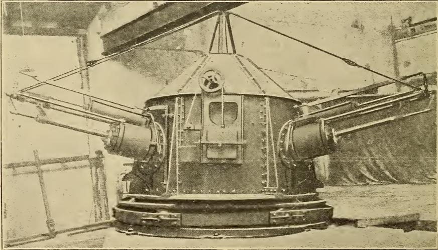
FIG. 2. STASSANO FURNACE IN OPERATION.
