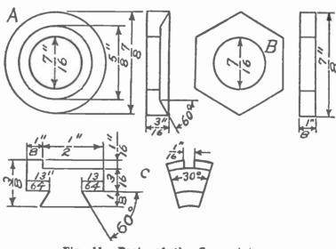
Fig. 11 .- Parts of the Commutator.
