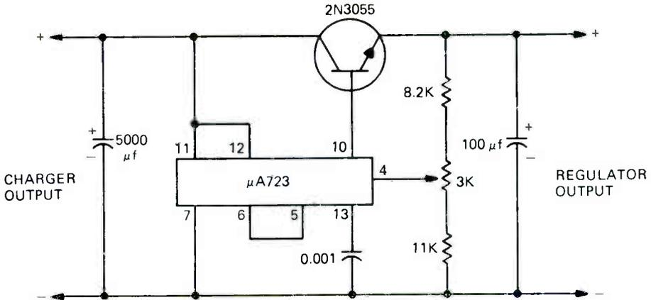
FIGURE 2. REGULATOR HUNG ACROSS CHARGER OUTPUT.
