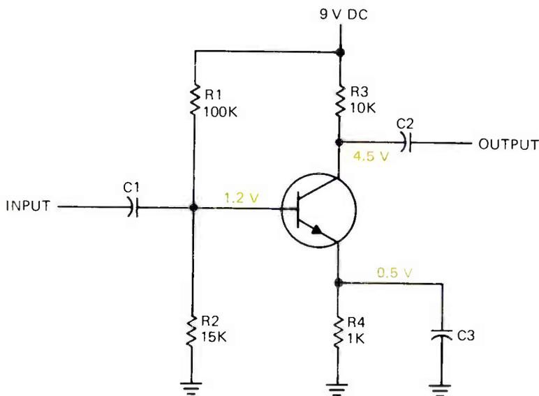
FIGURE 2. A TYPICAL COMMON-EMITTER NPN AMPLIFIER.
