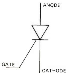
**FIGURE 1.** SCHEMATIC SYMBOL OF SCR.
