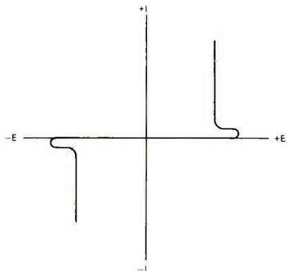
**FIGURE 5. CURVE OF A TYPICAL NEON LAMP.**
