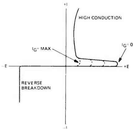
**FIGURE 2. E-I CURVE SHOWING BASIC SCR OPERATION.**
