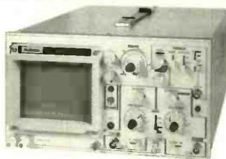
**20 MHz DUAL TRACE OSCILLOSCOPE**
