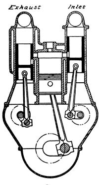
Fig. 4 Piston Valve Motor
