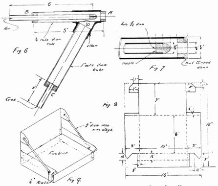
SHOWING CONSTRUCTION OF THE BLOWPIPE; AND THE SREET-IRON HEARTH.
