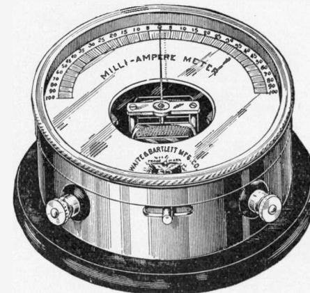
Fig. 5. Magnetic Mil-Ammeter
