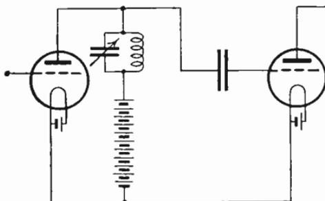
FIG. 3.—TUNED ANODE COUPLING
