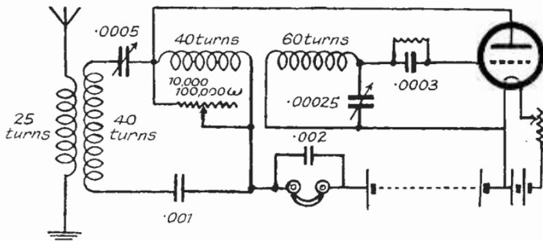
FIG. 2.—THE SUPER-SELECTIVE CIRCUIT
