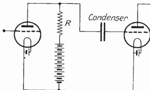
FIG. 1.—RESISTANCE COUPLING
