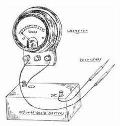
Fig. 1-Voltmeter Testing Outfit.
