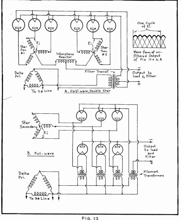
Three-Phase Rectifier Circuits.
