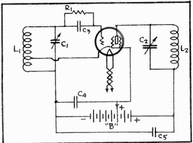
THE TUNED-PLATE, TUNED-GRID, PUSH-PULL OSCILLATOR
