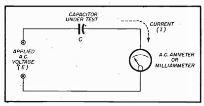
Fig. 1. Simple Reactance-Type Capacitance Meter.
