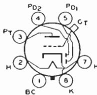
**TRIPLE DIODE—HIGH-MU TRIODE**
