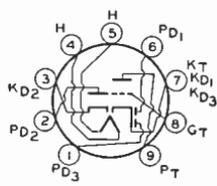
**TRIPLE DIODE—HIGH-MU TRIODE**
