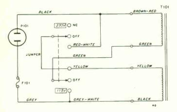
Figure 1-2. 115 or 230 volt Power Switch
