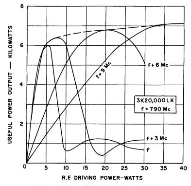
USEFUL POWER OUTPUT VS. R.F. DRIVING POWER (MIDDLE CAVITY DETUNED; INPUT & OUTPUT CAVITIES TUNED TO DRIVE FREQUENCY)
