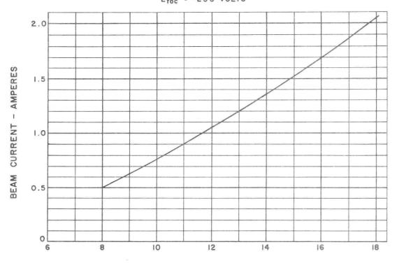
BEAM VOLTAGE - KILOVOLTS
