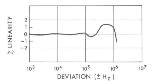
TYPICAL DEVIATION LINEARITY OF TRANSMITTER
