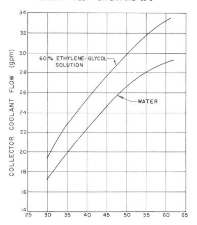
COLLECTOR DISSIPATION (kilowatts)
