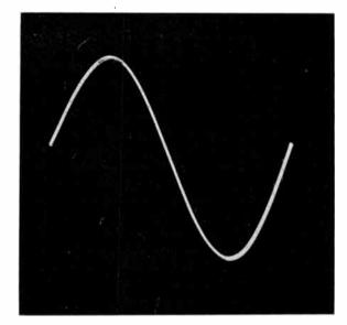
FIGURE 3-4 OSCILLOGRAM OF A 60-CYCLE SINE WAVE
