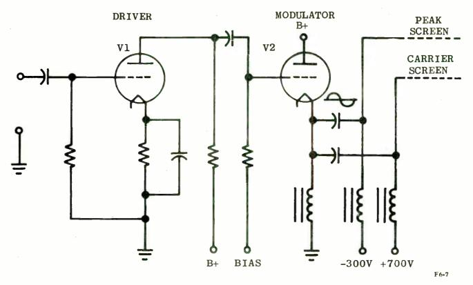
FIGURE 1.12. IMPEDANCE COUPLED CATHODE FOLLOWER MODULATOR
