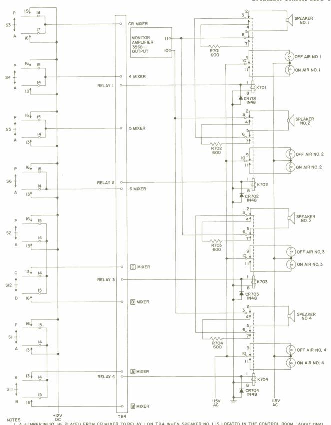
I. A JUMPER MUST BE PLACED FROM CR MIXER TO RELAY I ON TB4 WHEN SPEAKER NO. I IS LOCATED IN THE CONTROL ROOM. ADDITIONAL JUMPERS MUST BE PLACED BETWEEN RELAYS 2,3,4 AND THE ASSOCIATED MIXER WHEN THERE IS A SPEAKER IN A STUDIO WITH A MICROPHONE. 2. IF MORE THAN ONE MICROPHONE IS USED IN A SPECIFIC LOCATION, THE SWITCH CONTACTS FOR EACH SHOULD BE PARALLELED 8 JUMPERED ON TB4 SOTHAT EITHER MICROPHONE WILL OPERATE THE ASSOCIATED RELAY.
