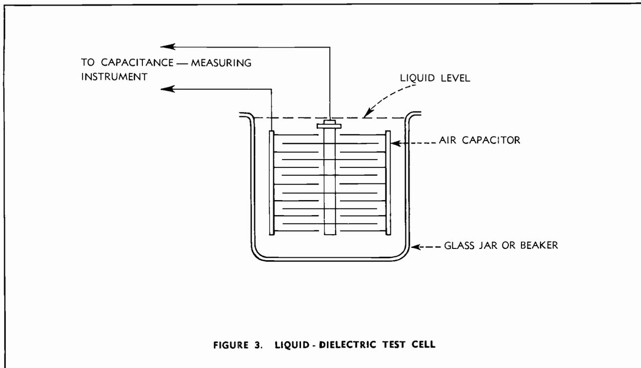
**FIGURE 3. LIQUID - DIELECTRIC TEST CELL**
