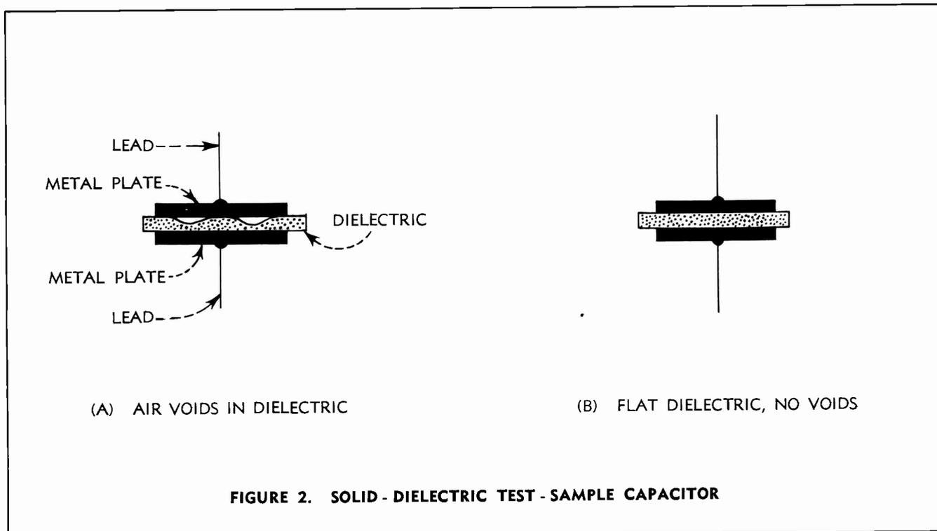
**FIGURE 2. SOLID - DIELECTRIC TEST - SAMPLE CAPACITOR**
