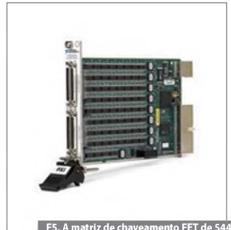
F5. A matriz de chaveamento FET de 544 pontos de cruzamento PXI-2535.
