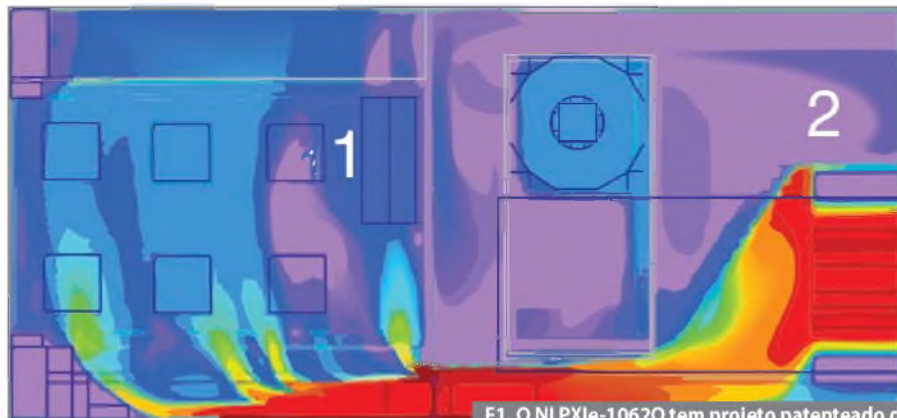
F1. O NI PXIe-1062Q tem projeto patenteado de ventoinha de resfriamento traseira.
