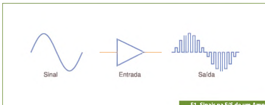
F1. Sinais na E/S de um Amplificador Classe D (digital).
