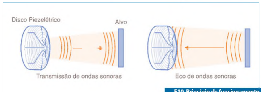
F10. Princípio de funcionamento do sensor ultrassônico.
