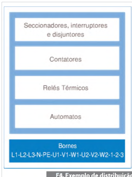
F4. Exemplo de distribuição da aparelhagem.
