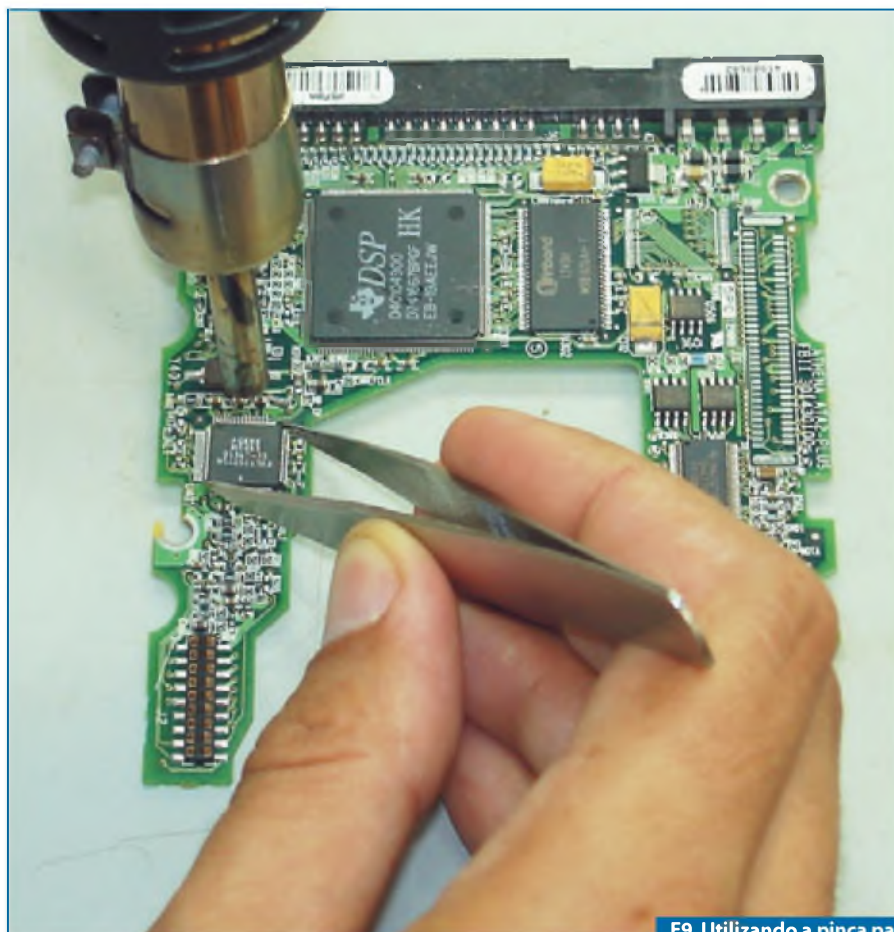
F9. Utilizando a pinça para auxiliar na extração do C.I.
