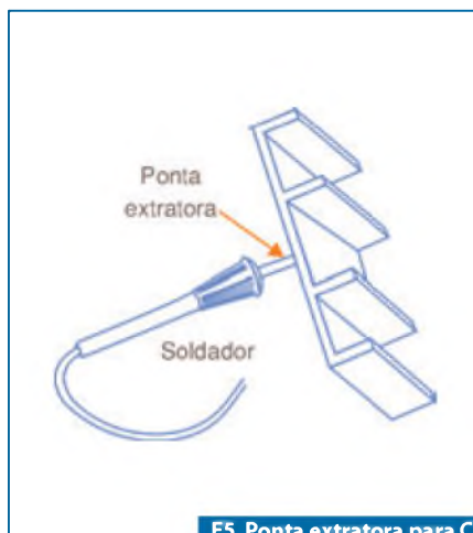
F5. Ponta extratora para CIs em invólucros DIL (DIP).
