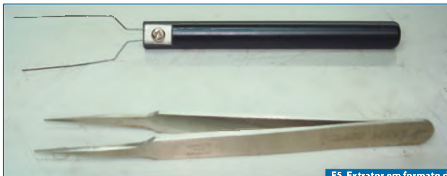
F5. Extrator em formato de “garfo” e pinça reta.
