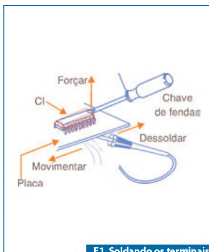
F1. Soldando os terminais e levantando o CI.
