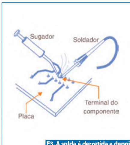
F3. A solda é derretida e depois é retirada com o sugador.
