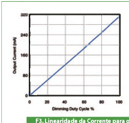
F3. Linearidade da Corrente para o PWM Dimming ( V_{IN}=10,8V ).
