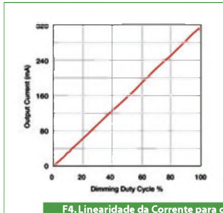
F4. Linearidade da Corrente para o Mixed Mode Dimming ( V_{IN}=10,8V )
