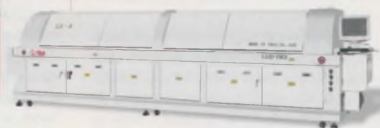
Figura 1 - Reflow oven de alta capacidade, com 8 zonas de controle térmico, próprio para operação lead-free . No detalhe, ventiladores de alta potência para obter precisão no perfil térmico.
