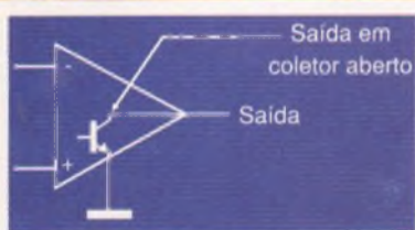
Figura 14 - As saídas dos comparadores LM139/239/339 em coletor aberto.
