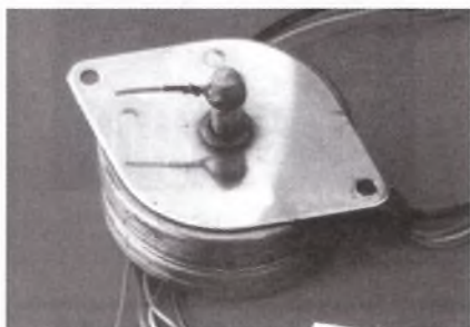
Fig. 1 - Motores de passo comuns - não devem ser confundidos com motores de corrente contínua.
