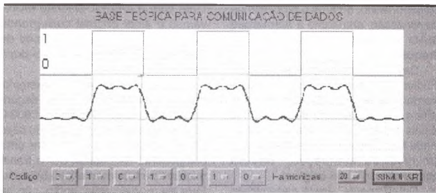
Figura 2: "Front-End" do simulador, plotando onda quadrada de código 0101010 e sua respectiva Série de Fourier, escrita com as 20 primeiras harmônicas, funcionando no browser Netscape em http://www.dt.fee.unicamp.br/~guido/fourier.html
