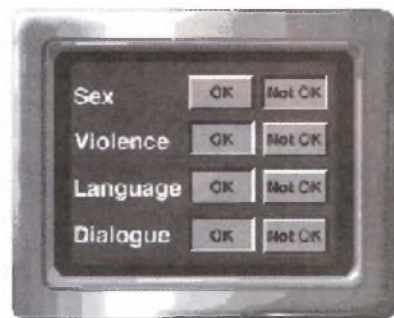
Fig. 1 - Tela apresentada num televisor quando o nível de um programa no que se refere a sexo, violência, linguagem e diálogo não está de acordo com o programado.
