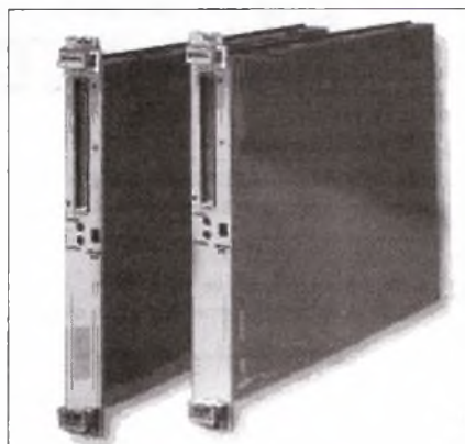
Fig. 1 - Placas de aquisição de dados da NATIONAL INSTRUMENTS com 64 entradas analógicas, 12 bits de resolução e velocidade de 1,25 MSPS.
