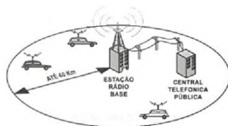
Fig. 1 - O sistema permitia no máximo 50 assinantes por canal e tinha uma potência de 200 W por canal.
