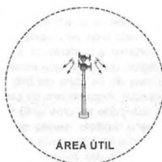
Fig. 5 - Área de cobertura sem os obstáculos.
