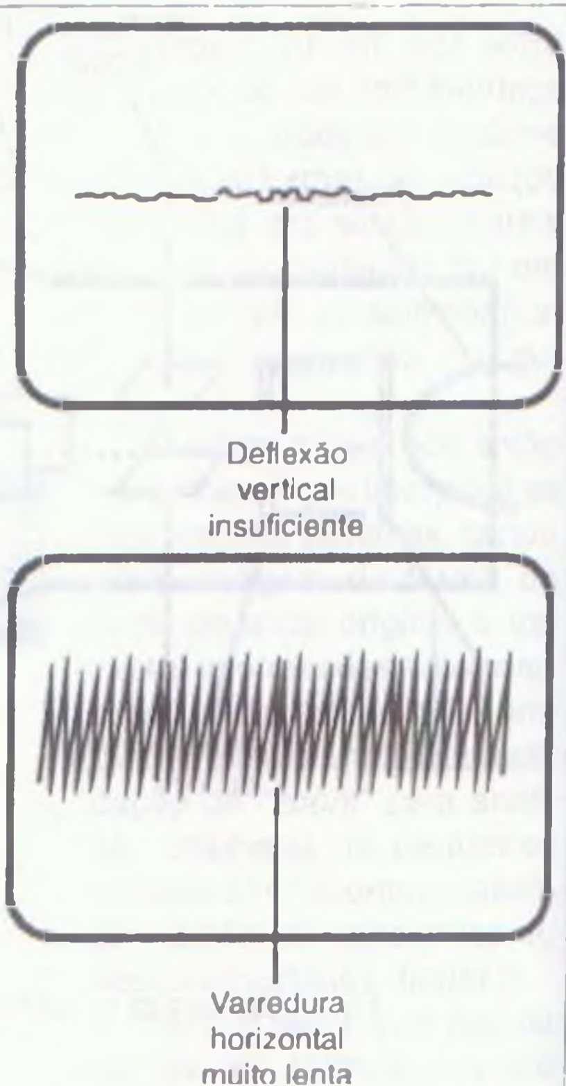
Fig. 9 - Ganhos e frequências devem ser compatíveis para obtenção de uma boa imagem.
