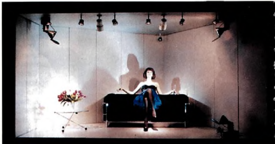
Associação de lâmpadas Dicroicas com as de vapor metálico. Mescla lâmpada com efeitos de cor quente (dicroica) com lâmpadas de cor fria.
