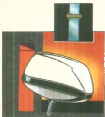
Junção do cone ao conjunto painel-tela-máscara-blindagem
