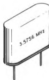
Figura 2 - Aspecto de um cristal de quartzo da forma como aparece nos receptores de TVC.
