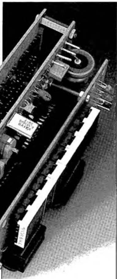
Vue en diagonale d'un module-fréquence-mètre terminé.
