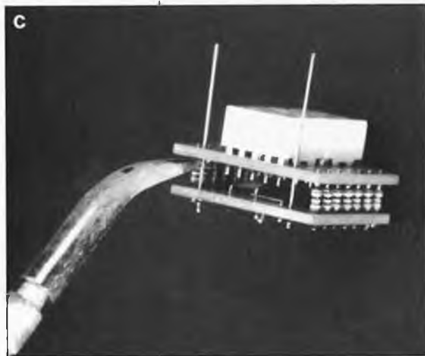
Figure 3. Réalisation du sandwich. a) On couche le condensateur à plat sur la platine. b) Mise en place des interconnexions effectuées à l'aide de l'une des pattes de chacune des résistances. c) Interconnexion des lignes d'alimentation. d) Connexion au bus des adresses des locomotives.
