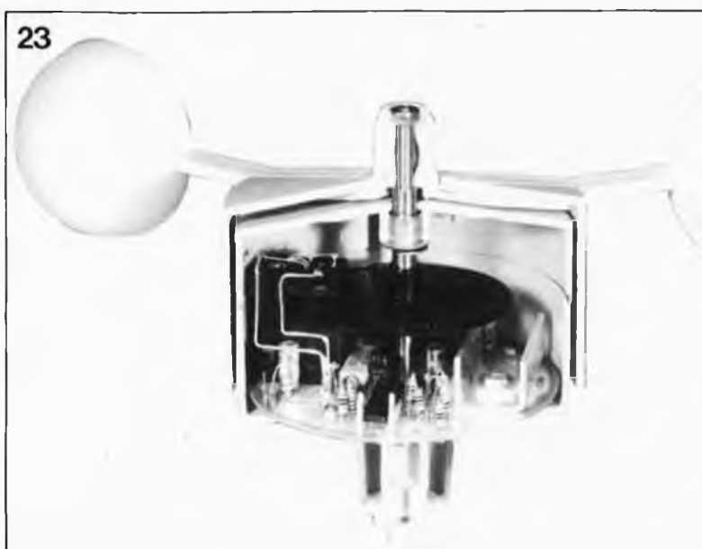
Figure 23. Vue "écorchée" d'une girouette terminée, affublée des ailes de l'anémomètre.
