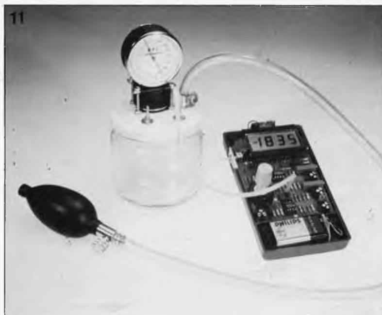
Figure 11. Modèle de minicaisson de compression à air. Il utilise l'air plutôt que l'eau. Ses extensions sont "empruntées" à un sphygmomanomètre.
