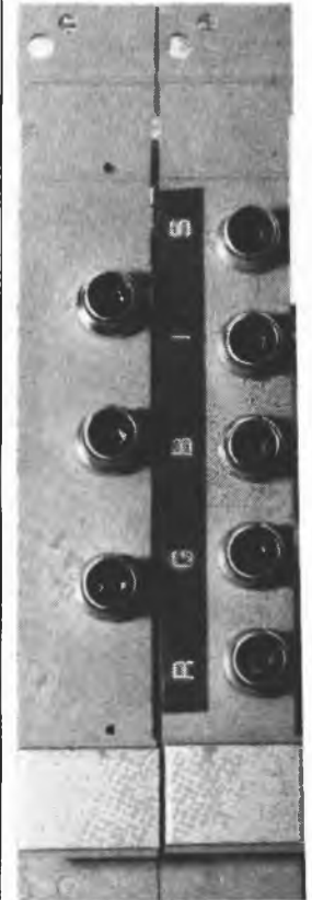
Exemple de face avant pour la carte graphique montée dans un rack 19 pouces: à droite, les sorties R, G, B, I et Sync, et à gauche les sorties I (N & B), Sync et Sync.
