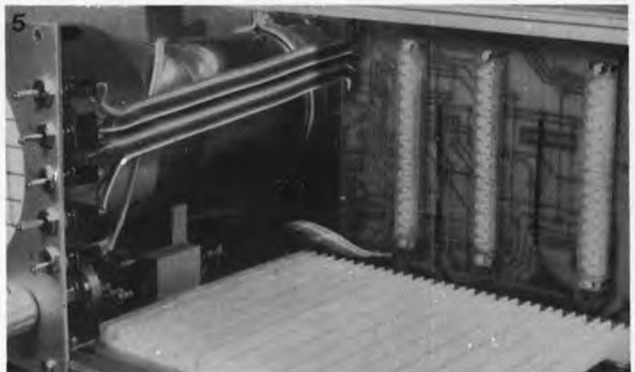
Photo 5. Vue de l'oscilloscope, cartes de base de temps et module Y enlevés, avec la carte mère et le câblage vers le Face avant du tube.
