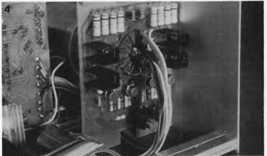
Photo 4. Câblage de l'amplificateur X et Y et de l'embase du tube.
