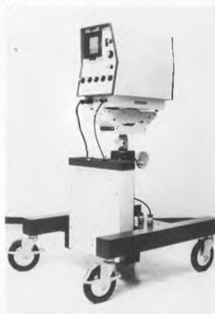
Photo 1. Le coeur de cette caméra ultrasensible aux infrarouges est constitué d'un capteur infrarouge refroidi par de l'azote liquide.
