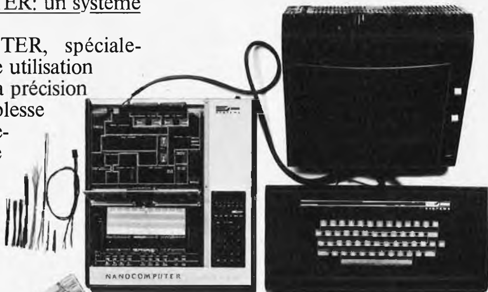
NBZ80-HL. Comme le NBZ80-S, avec 16K byte de RAM, carte d'interface vidéo, clavier alphanumérique, 8K ROM de BASIC, guide du BASIC. (Le moniteur vidéo est en option).
