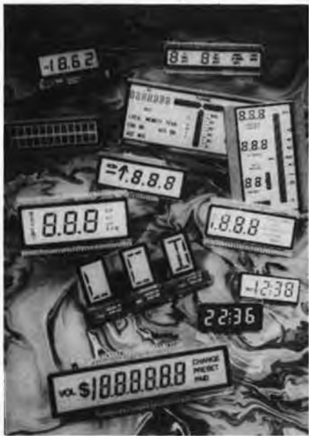
Photo 1. Les afficheurs à cristaux liquides autorisent une grande variété de formes et de tailles.
