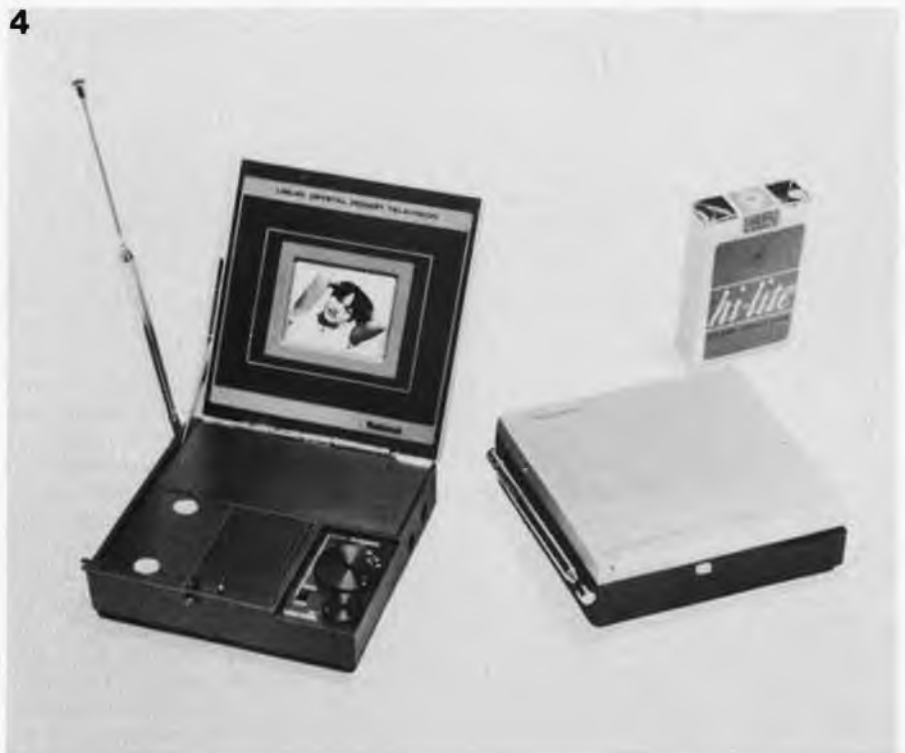
Photo 4. Un écran à cristaux liquides équipe un prototype de poste de télévision de poche, fabriqué par National Panasonic (Matsushita) comportant 57 000 points. Il fonctionne sous une tension d'alimentation de 4,6 V.
