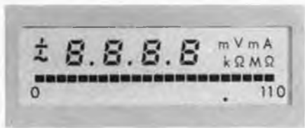
Photo 2. Un ensemble de mesures de valeurs digitales et analogiques, utilisant les afficheurs à cristaux liquides.
