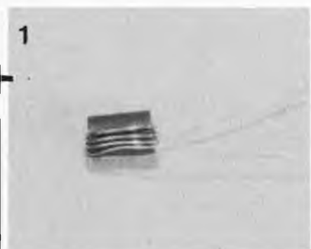
Photographie 1. Inductances L2, L3, L4, L5 constituées de 5 spires en cuivre émaillé de 0,2 mm de diamètre enroulées toroïdalement autour d'une perle de ferrite.
