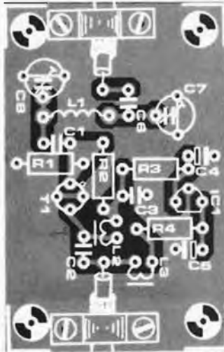
Figure 8. Circuit imprimé et implantation des composants du circuit représenté figure 7.
