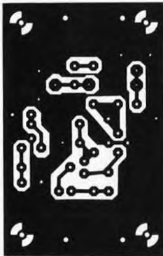
Figure 8. Circuit imprimé et implantation des composants du circuit représenté figure 7.
