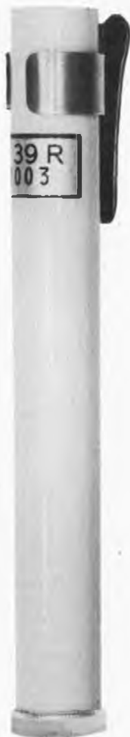
Photo 2. Modèle industriel de dosimètre de poche. Cet appareil sert à la mesure de la dose des radiations auxquelles le porteur est exposé. Pour l'utilisation, il est chargé à une tension fixe. La chute de tension est proportionnelle à la dose et s'inscrit sur une échelle graduée.
