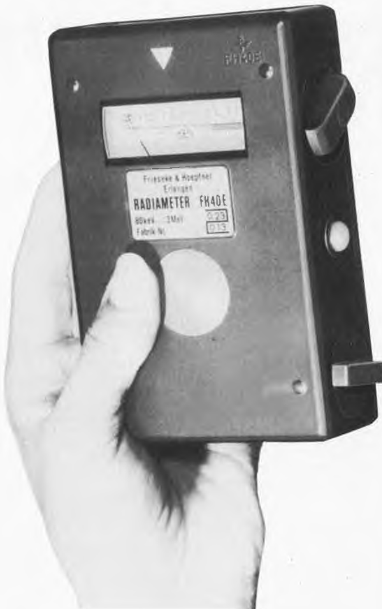
Photo 3. Modèle industriel de compteur Geiger-Müller. Ce détecteur électronique enregistre, à l'aide d'un tube compteur, la présence de toute particule ionisante.
