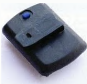
Obr. 10. Zadní strana krabičky s „vytisknutým“ držákem
