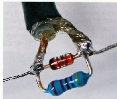
Obr. 2. Praktické provedení s 1N4148 pro 2,4 GHz
