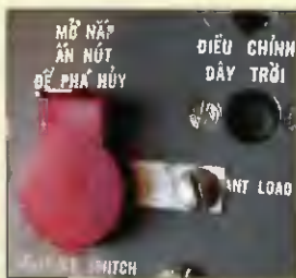
Obr. 78. Detail destruktčního tlačítka u transceiveru TR-20
