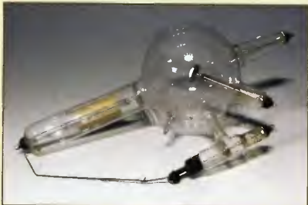
Obr. 12. Rentgenová lampa z počátku minulého století
