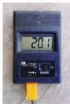
Obr. 3. Termočláňkový měřič teploty
