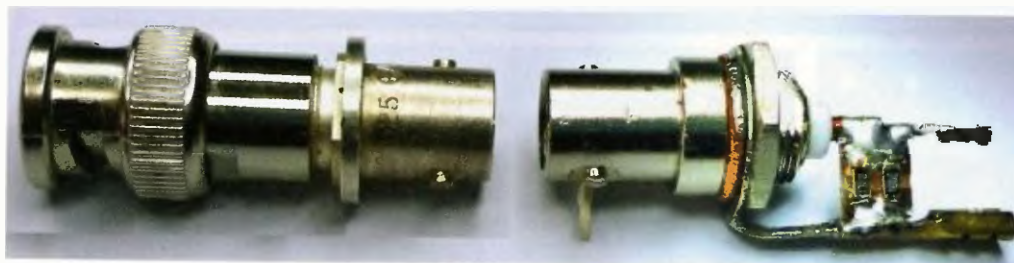
Obr. 13. Realizace průchozí zátěže 50 Ω a přípravku pro kontrolu sond
