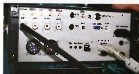
Obr. 5. Zadní panel SunSDR-MB1 (vpravo)
