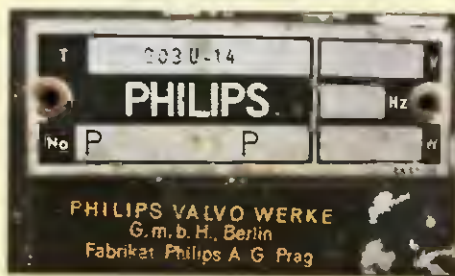
Obr. 8. Štítek z univerzálního přijímače 203U, který byl vyráběn za války v Praze - Hloubětíně
