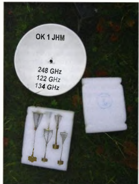
Obr. 3. Parabola OK1JHM pro tři pásma a sada výměnných ozářovačů
