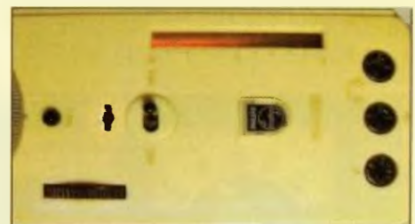
Obr. 6. Fotografie svítící neonové indikační trubice
