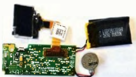
Elektronické součásti náramku Fitbit Force
