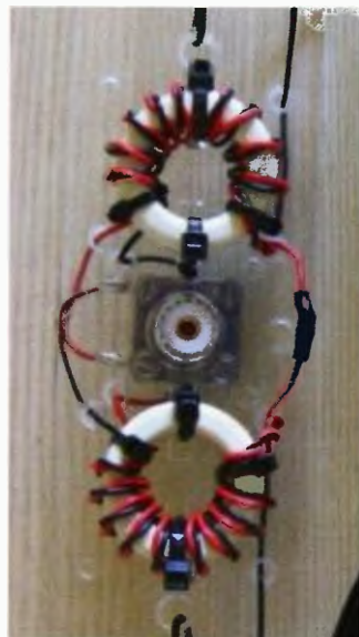
Obr. 2. Dvoujádrový balun s dvojicí zkroucených vodičů
