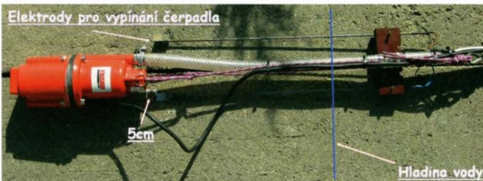
Obr. 3. ↓ Čerpadlo a provedení elektrod. Dolní konce elektrod jsou 5 cm nad úrovni sacího otvoru čer- padla, aby se čerpadlo vypnulo dříve, než začne na- sávat vzduch
