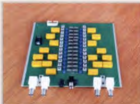
Kryštálový IF filter 14 MHz na zníženie fázového šumu vysielateľa 144 MHz
