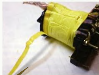
Obr. 15. Vyrovnávací a izolační pásy na okraji cívky
