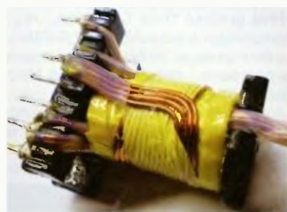
Obr. 16. Sekundární vinutí z více drátů a izolace vývodů
