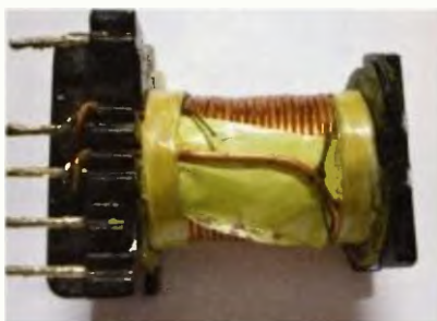
Obr. 22. Vyplnění a izolace okraju vinutí
