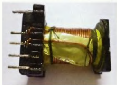
Obr. 21. Upevnění koncu a izolace vývodu vinutí
