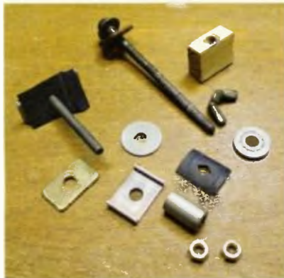
Obr. 18. Držáky na uchycení cívky při navijení
