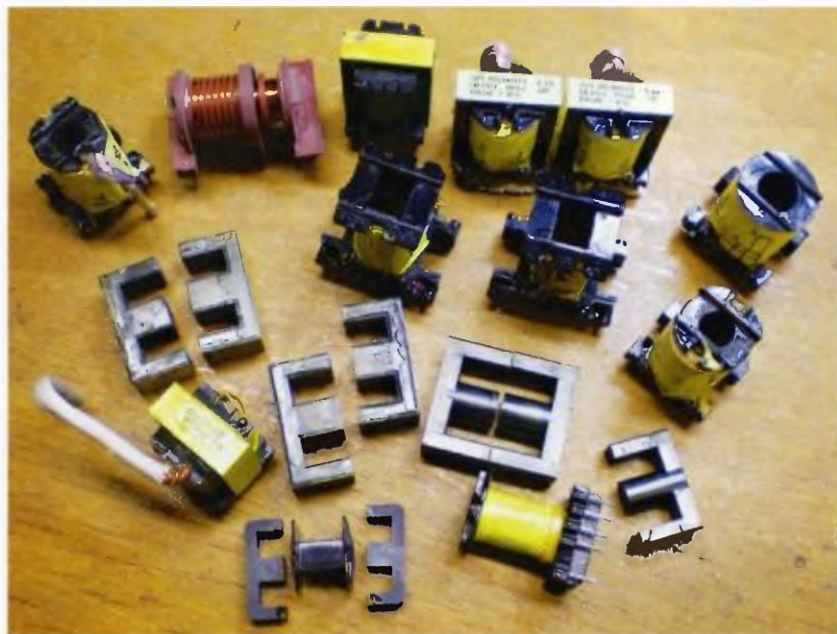
Obr. 14. Rozebrané impulzní transformátory
