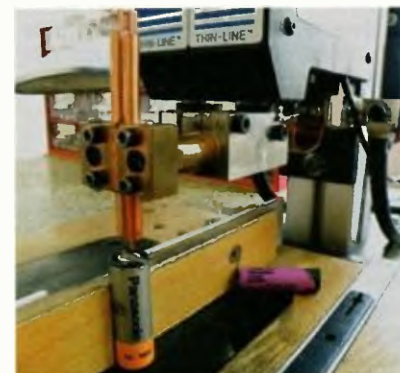
Obr. 2. Bodování pájecích vývodů
