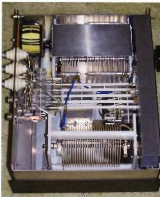
Obr. 30. Anténní tuner a jeho vnitřní provedení
