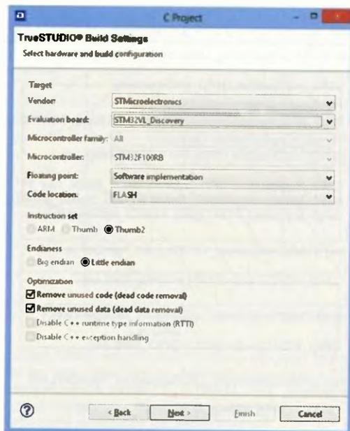
Obr. 10. Výber typu vývojovej dosky →
