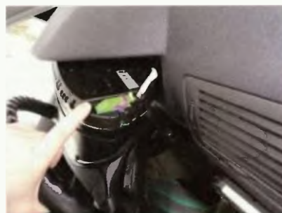
Obr. 9. 32-pinový konektor na paneli prístrojov
