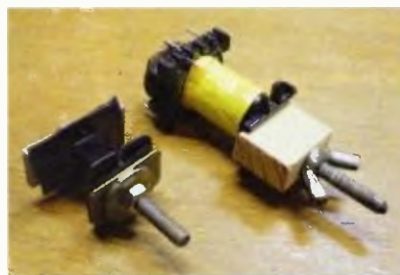
Obr. 19. Držáky s cívkami na navijení
