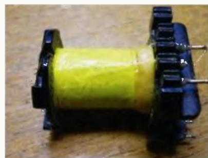
Obr. 17. Cívka připravená k převinutí
