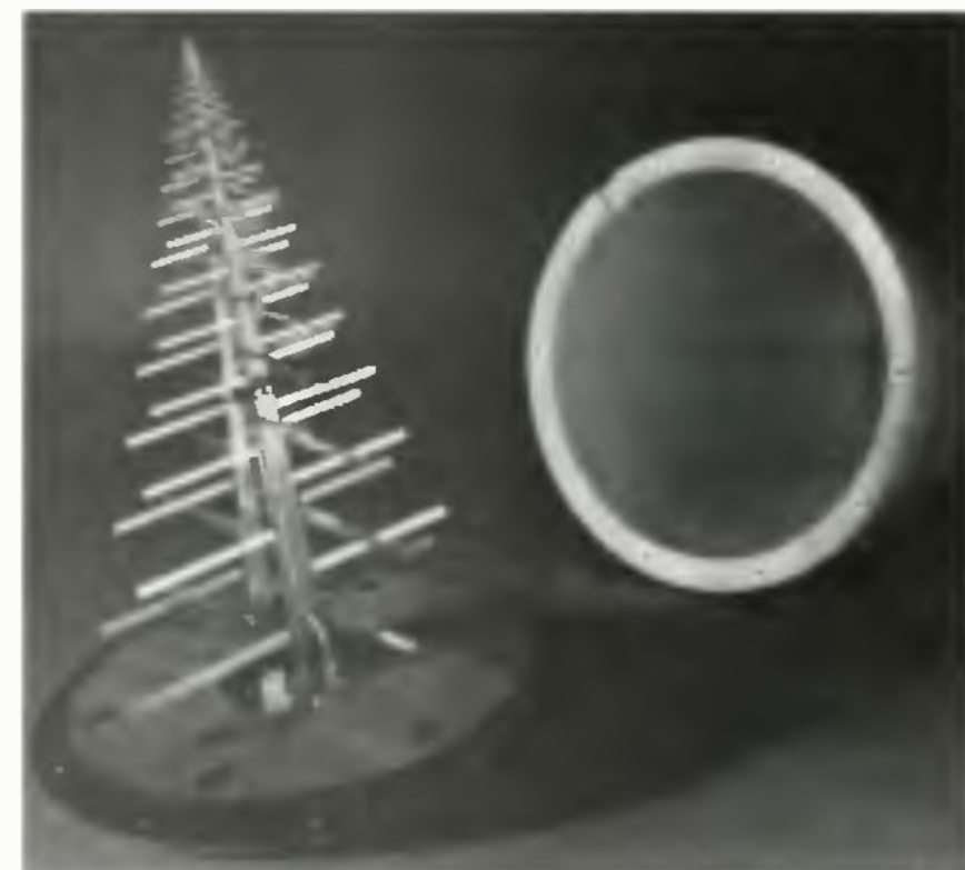
Obr. 7. LPD anténa vyjmutá z krytu primárního ozařovače parabolické antény měřicí soupravy fy Rohde&Schwarz v pásmu 1 až 18 GHz
