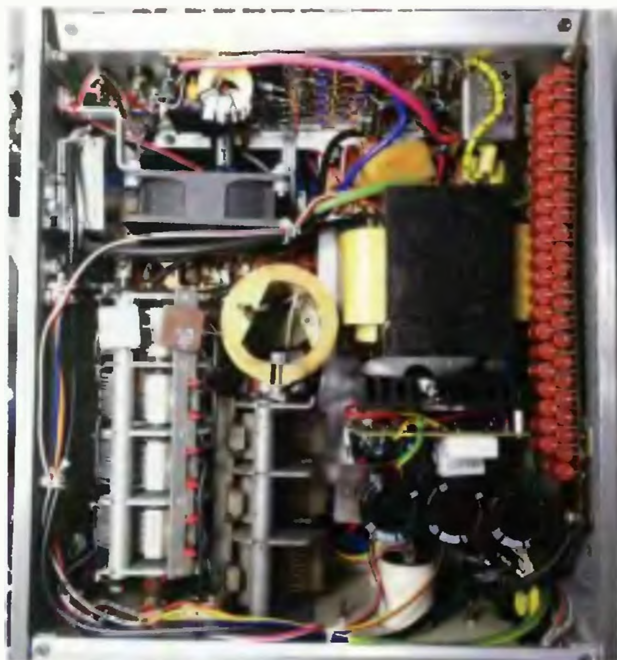
Obr. 8. Foto umístění PA ve skříni společně s anténním členem typu Z-match a umělou anténou (zátěží) 50 \Omega
