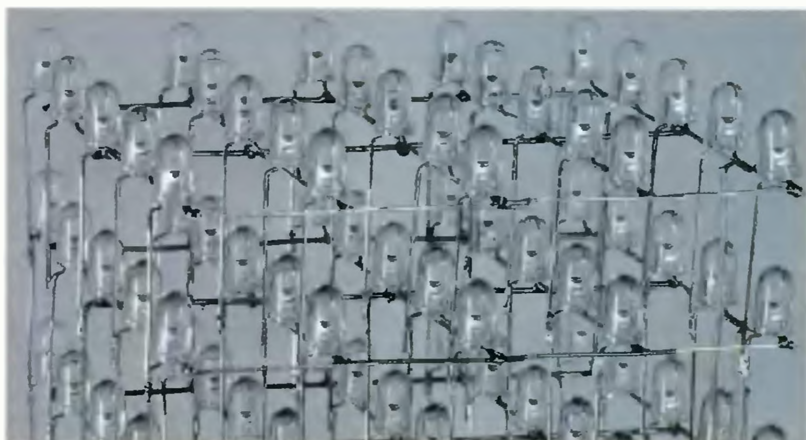
Obr. 8. Detail pospájania LED diód
