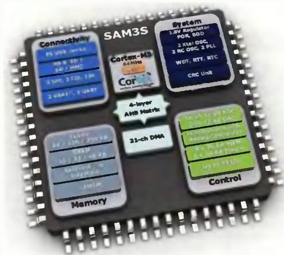
Obr. 2 Príklad architektúry procesora Atmel SAM3S názorne ilustruje, ako je do nej zakomponované štandardizované jadro Cortex M3 so širším okolím. Bloky System, Connectivity, Memory a Control doplnil výrobca ako špecifické pre konkrétny typ procesora
