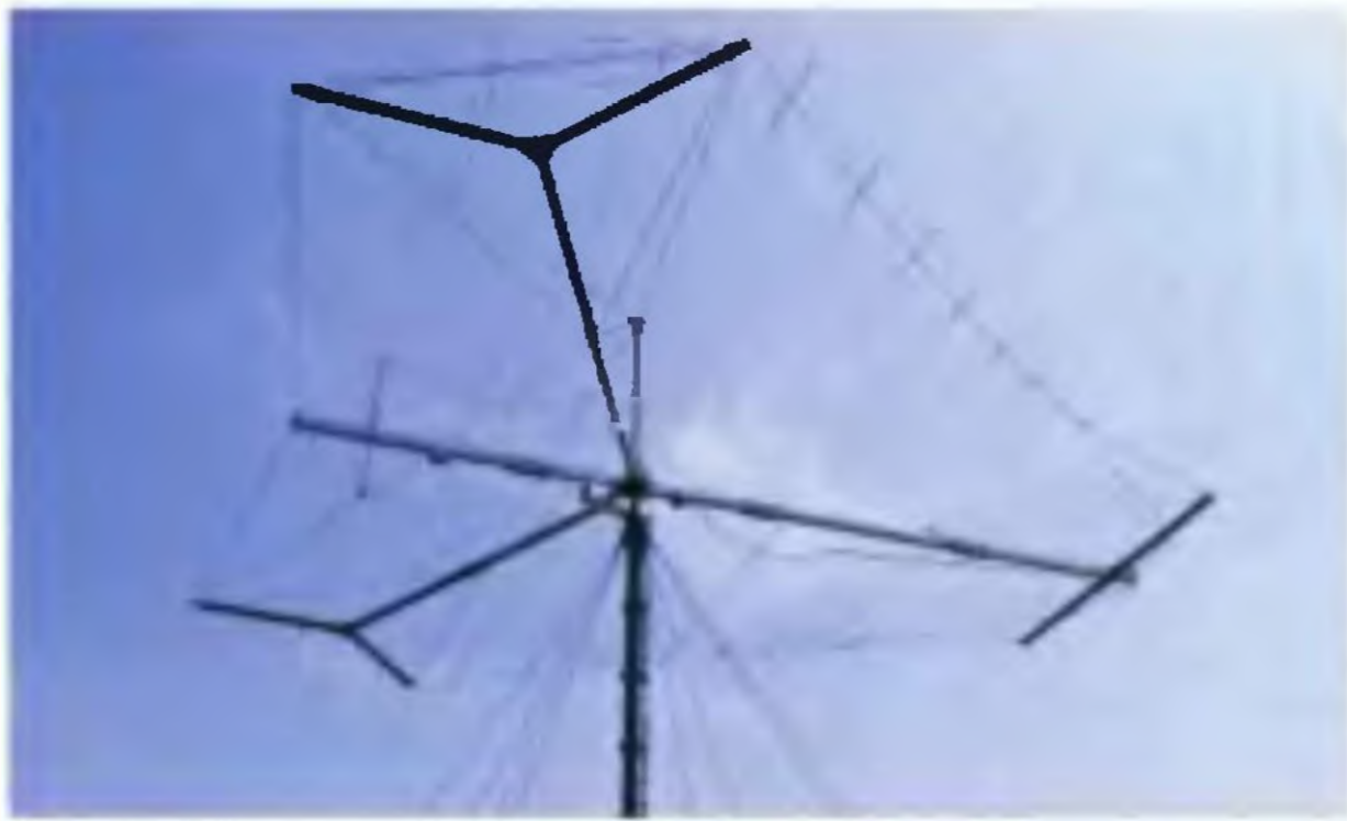
Obr. 4 a 5. LPD anténa fy Rohde&Schwarz, typ HL451 pro příjem od 2 do 30 MHz a pro vysílání od 5 do 30 MHz. „Zvlnění“ zkrácené drátové dipólové prvky, které podstatně zmenšují velikost antény, jsou izolovaně zavěšeny na nosné konstrukci. Zvlnění prvku je patrné na zvětšeném výřezu na obr. 5
