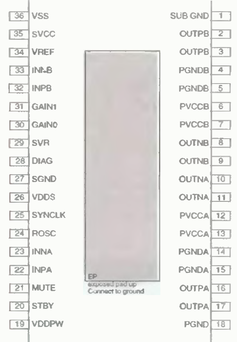
Obr. 48. Zapojení vývodů obvodu TDA7492
