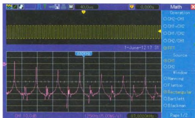
Obr. 26. Hantek 5202B - frekvenční analýza průběhu
