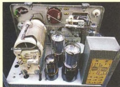
Obr. 4. Pohled dovnitř vysílače RSI
