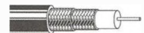
Obr. 12. Kabel se zlepšeným stíněním s dvojitým opletením. Opletení je dvouvrstvé, vzájemně propojené. Speciální kabely mohou mít až 5násobné opletení
