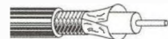
Obr. 11. Kabel se zlepšeným stíněním s přidáním stínicí fólie. Fólie je obvykle měděná, pouze u levných kabelů může být hliníková
