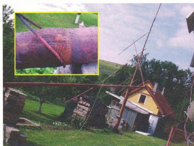
Obr. 11. A „blesková“ deštrukcia môjho anténneho stožiaru
