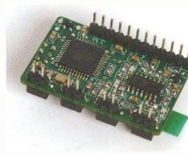
Obr. 4. Modul je připraven k zasazení do zkušebního pole
