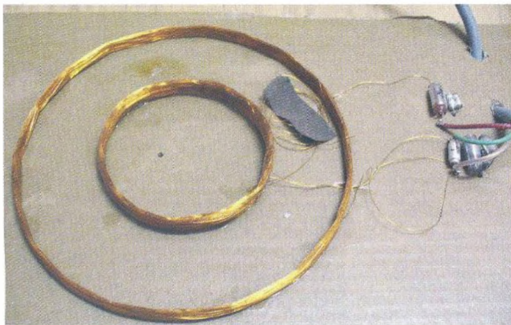
Obr. 6. Fotografie srovnávající vinutí klasické koncentricky a cívky s neutralizačními smyčkami
