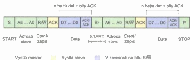
Obr. 79. Kombinovaný formát přenosu při použití 7bitové adresy s opakovaným generováním podmínky START (Sr). Tímto způsobem může obvod master změnit směr přenosu dat nebo vybrat jiné zařízení slavy, aniž by přerušil přenos podmínkou STOP
