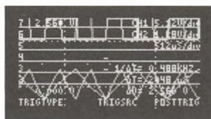
Obr. 11. Všeho moc škodí, křivky z paměti a aktuální se smísí ve změť
