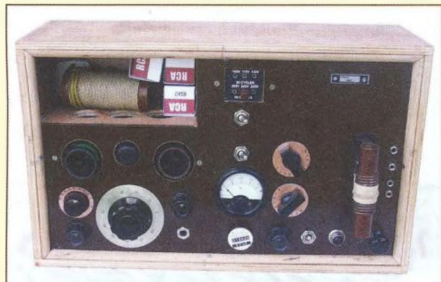
Obr. 7. Radiostanice MARK V, elektronky 6SK7 (3x), 6V6, 832, 5Z3 (replika)
