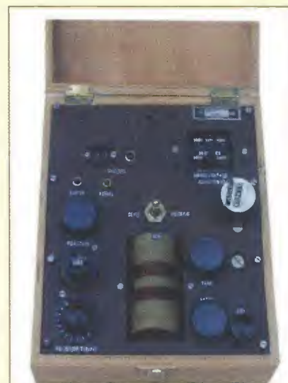
Obr. 11. Radiostanice MARK VI (varianta 3), elektronky 6SK7, 6C5 (2x), 6V6, 6X5 (replika)
