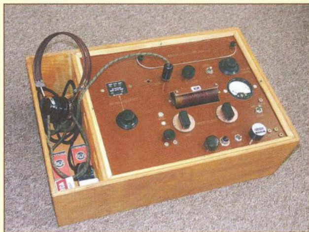
Obr. 8. Radiostanice MARK VI (Libuše), elektronky 6SK7, 6C5 (2x), 6V6, 807, 5Z3, 6X5 (replika)
