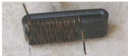
Obr. 16. Výstupní transformátor na odrušovacím feritovém jádře
