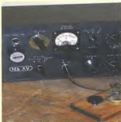
Obr. 10. Radiostanice MARK XV (3 díly), elektronky 6SK7 (3x), 6F6, 6L6, 5T4, 6X5 (replika, jen vysílač)
