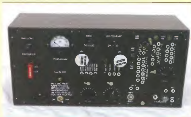
Obr. 12. Vysílač „ŠIMANDL“, elektronky 6V6 (2x), 807 nebo 6L6 (2x), (replika)
