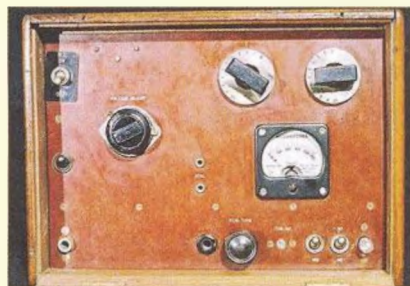
Obr. 6. Vysílač MARK III, elektronky 6V6 (6L6), 807 (vlevo)
