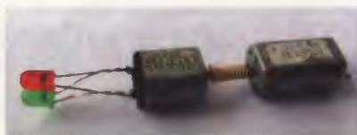
Obr. 3. Motorgenerátor s indikací změny směru otáčení
