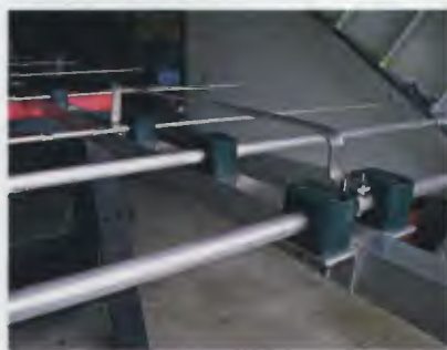
Obr. 4 a 5. Symetrizace pomocí modifikovaného Pawseyho členu
