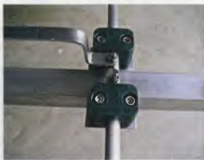
Obr. 4 a 5. Symetrizace pomocí modifikovaného Pawseyho členu
