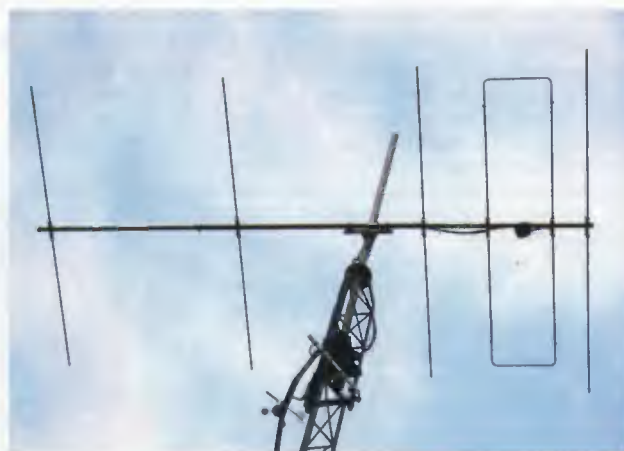
Obr. 6. Konstrukční náčrtek krátké pětivrčkové antény pro 50, 150 MHz
