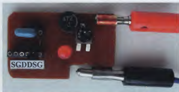
Obr. 13. Pohled na desku zkoušečky krystalů, keramických rezonátorů a tranzistorů JFET ze strany součástek
