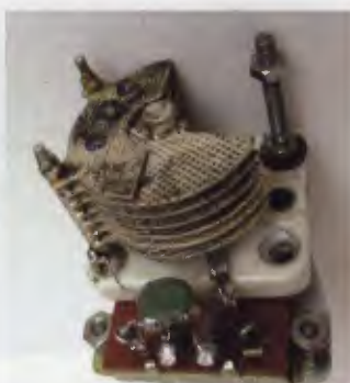
Obr. 3. Použitý inkurantní ladicí kondenzátor
