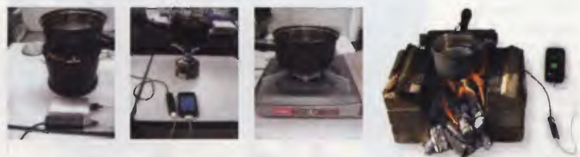
K zahřívání hrnce s termočlánky lze použít různé zdroje tepla
