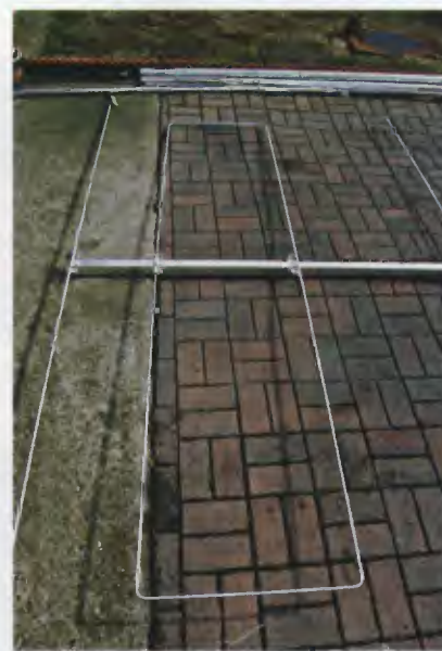
Obr. 3. Izolované upevnění prvků k nosnému ráhnu
