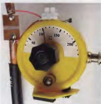
Obr. 2 b. Smyčka v rezonanci Stupnice ukazuje kapacitu ladicího kondenzátoru v pF
