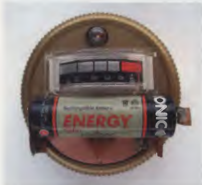
Obr. 2. Praktické provedení testeru nabití článků NiCd a NiMH, zkoušený článek je plně nabitý
