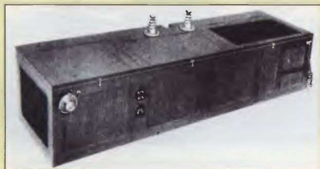
Obr. 2. První vysílací stanice 75 W zvaná „Bedna na vajíčka“ na vzducholodě Parseval
