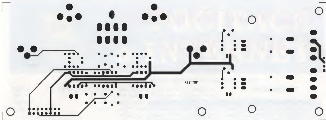
Obr. 17. Deska s plošnými spoji vstupů a napájecího zdroje ze strany součástek (TOP)
