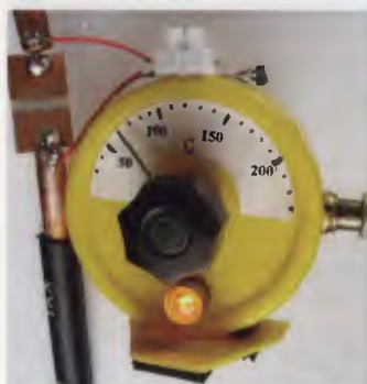
Obr. 2 a. Smyčka mimo rezonanci Stupnice ukazuje kapacitu ladicího kondenzátoru v pF
