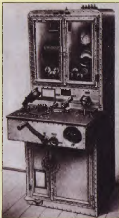
Obr. 3. 800W dřevěná skříňová stanice (K nebo L) typu ALS 45. Přijímač 100 – 1200 kHz, vysílač 136 – 375 kHz
