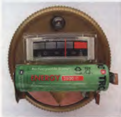
Obr. 3. Článek NiMH připojený k testeru je vybitý
