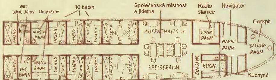
Obr. 1. Rozložení místností na palubě vzducholodě Zeppelin
