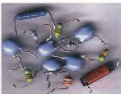
Obr. 11. Kořistní cívky, které byly měřeny popisovaným měřičem malých indukčností
